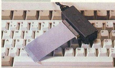
ga-Tastenfeld verwenden, liefert Micronik optional ein Tastaturgehäuse vom Amiga 4000. Darin wird das Tastenfeld untergebracht und über einen Adapter und ein langes Spiralkabel mit dem Amiga 1200 verbunden. Beide Alternativen bieten Vorteile, wobei die zweite Lösung unter Umständen etwas teurer werden kann.
