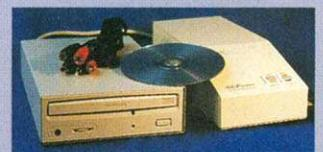
**Das Plus:** Am CD-1200 Plus laufen alle ATAPI-kompatiblen CD-ROM-Laufwerke
